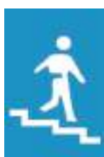
(Π - 62) Κάτω (υπόγεια) διάβαση πεζών
